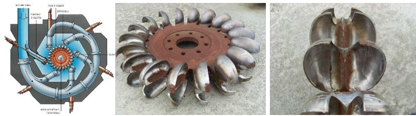
Figure 8 : Schéma d'une turbine Pelton à 6 injecteurs et images d'une roue Pelton ainsi que de la forme de ses augets
